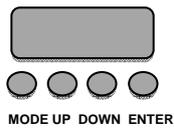
Durch Drücken der Mode-Taste können Sie sich im Hauptmenü bewegen. Durch Drücken der Up/Down-Taste können Sie die Auswahl verändern. Bestätigen Sie jede Änderung durch Drücken der Enter-Taste. Der jeweilige Modus kann durch die Mode-Taste verlassen werden. Die jeweiligen Funktionen werden im Folgenden aufgeführt.
