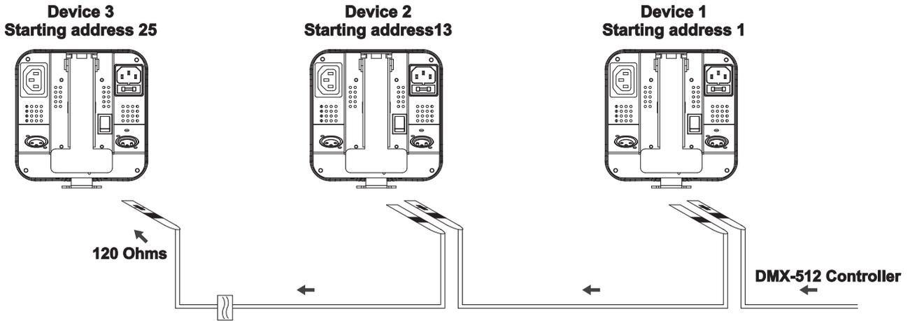
**Achten Sie darauf, dass die Adern der Datenleitung an keiner Stelle miteinander in Kontakt treten. Die Geräte werden ansonsten nicht bzw. nicht korrekt funktionieren.**
