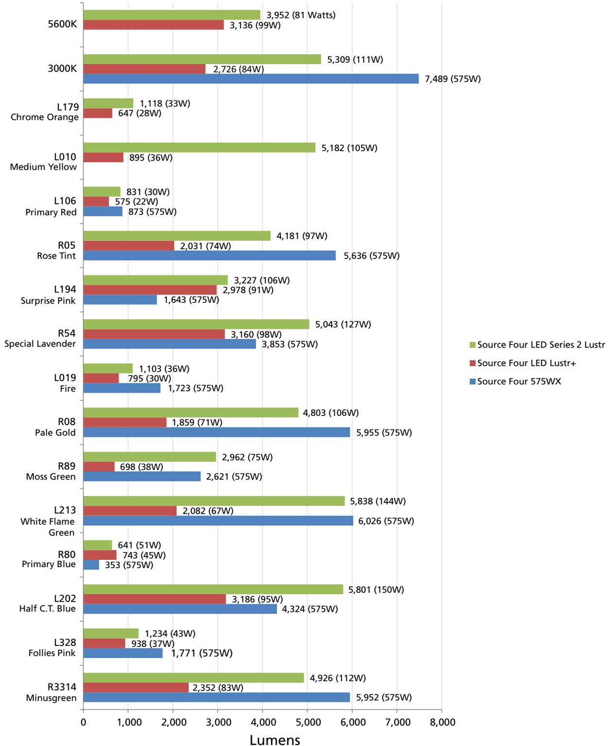
FIXTURE COMPARISON - DAYLIGHT HD AND TUNGSTEN HD
