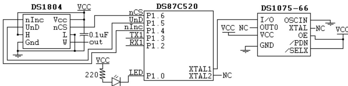
**Figure 1. Schematic Showing the DS87C520, DS1804, and DS1075 Connections**
