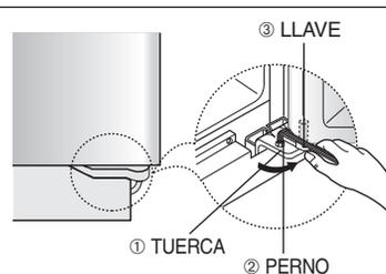
2) Ajuste la diferencia de altura entre las puertas girando el perno (②) en el sentido de las agujas del reloj (↻) o en sentido inverso (↺).
