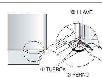
3) Después de ajustar las puertas, gire la tuerca en el sentido de las agujas del reloj (↻) hasta que llegue al extremo inferior del perno, seguidamente apriete de nuevo el perno con la llave (③) para fijar la tuerca (①).
