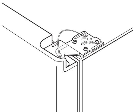
5) Coloque la parte frontal de la cubierta de la bisagra superior (⑪) sobre la parte frontal de la bisagra superior (⑫) y vuelva a montarla, empezando por la parte frontal de la cubierta.
