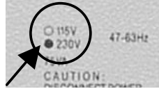
Abb. 4 Markierung der werkseitig eingestellten Betriebsspannung
