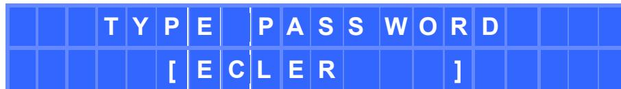
Mediante el control giratorio se edita el carácter seleccionado, y mediante las teclas PARAM se selecciona el siguiente carácter a editar. Finalmente, se pulsa SHIFT + ENTER para validar la contraseña introducida.
