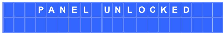
L'appareil est temporairement débloqué, jusqu'à ce qu'il reste plus de 2 minutes sans activité sur la face avant ou que vous affichez de nouveau le menu de verrouillage (PARAM gauche et droite simultanément, pendant 2 secondes) pour confirmer ou modifier le mode de verrouillage, auquel cas vous reviendrez à la demande de mot de passe (le même ou un nouveau), qui sera actif à partir de sa validation (SHIFT + ENTER).
