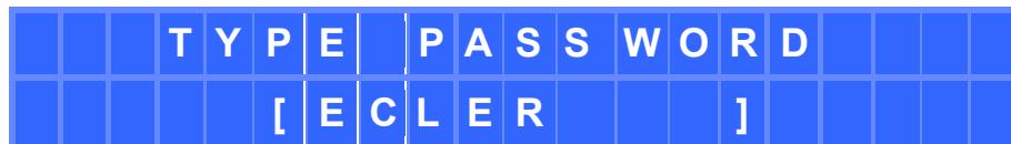
Mit Hilfe des Drehreglers wird das ausgewählte Zeichen eingegeben, und mit Hilfe der PARAM-Tasten wird das nächste zu bearbeitende Zeichen gewählt. Abschließend wird durch Drücken der Tasten SHIFT + ENTER das eingegebene Passwort bestätigt.
