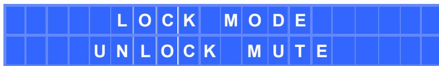
Mediante el control giratorio es posible cambiar el modo de bloqueo deseado y, a continuación pulsar SHIFT + ENTER para confirmar la selección. Si se selecciona uno de los dos modos protegidos mediante contraseña (LOCK ALL ó UNLOCK MUTE), la siguiente pantalla solicita introducir la contraseña de bloqueo:
