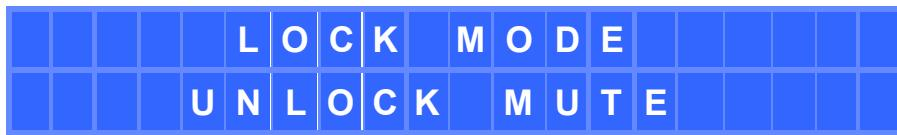
Avec la commande rotative, il est possible de changer le mode de verrouillage souhaité ; puis pressez SHIFT + ENTER pour confirmer la sélection. Si vous sélectionnez un des deux modes protégés par mot de passe (LOCK ALL ou UNLOCK MUTE), l'écran suivant demande le mot de passe de verrouillage :
