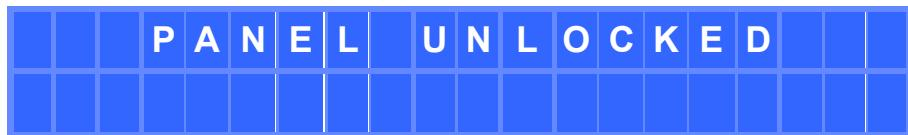
Das Gerät ist jetzt vorübergehend freigegeben, und zwar so lange, bis entweder 2 Minuten vergangen sind, ohne dass irgendeine Einwirkung auf die vordere Bedientafel erfolgt wäre, oder bis sich der Anwender erneut ins Sperrmenü begibt (PARAM rechts und links gleichzeitig 2 Sekunden lang gedrückt), um den Sperrmode zu bestätigen oder zu ändern. In diesem Fall wird erneut die Eingabe eines Passworts verlangt (desselben oder eines neuen), welches ab Bestätigung (SHIFT + ENTER) aktiv ist.
