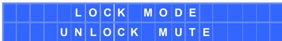
Mit Hilfe des Drehreglers kann der Sperrmodus geändert werden. Danach zur Bestätigung der Auswahl SHIFT + ENTER drücken. Wird einer der beiden passwortgeschützten Modi gewählt (LOCK ALL oder UNLOCK MUTE), so öffnet sich ein Fenster, in dem die Eingabe des Sperr-Passworts verlangt wird:
