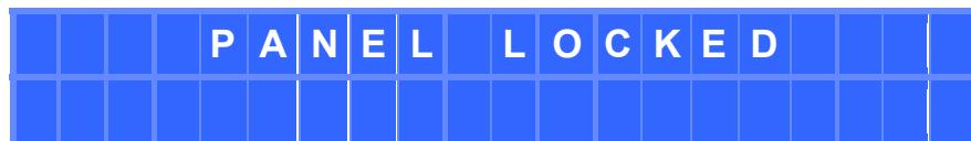
Um die Bedienelemente der vorderen Bedientafel wieder freizugeben, ist die Eingabe des gespeicherten Passworts erforderlich. Begeben Sie sich hierfür ins Sperrmenü (rechte und linke PARAM-Taste gleichzeitig 2 Sekunden lang gedrückt halten). Es öffnet sich folgendes Fenster:
