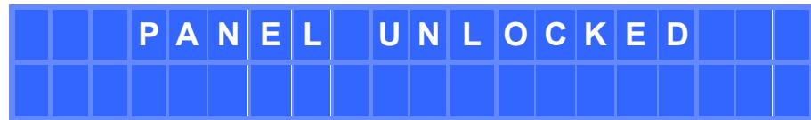
El equipo quedará temporalmente desbloqueado, hasta que transcurran 2 minutos sin actividad sobre el panel frontal o bien se acceda de nuevo al menús de bloqueo (PARAM derecha e izquierda simultáneamente, durante 2 segundos) para confirmar o modificar el modo de bloqueo, en cuyo caso se volverá a solicitar la contraseña (la misma o una nueva), que será activa a partir de su validación (SHIFT + ENTER).
