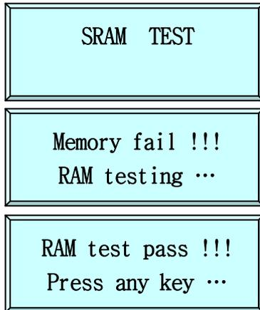
. To test the SRAM memory, press <ENT> key.
