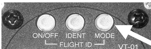
Der aktive Mode (im Beispiel ALT) wird in der Mitte der unteren Displayzeile angezeigt. Durch Drücken der Taste Mode können Sie zwischen folgenden Modi wechseln:
