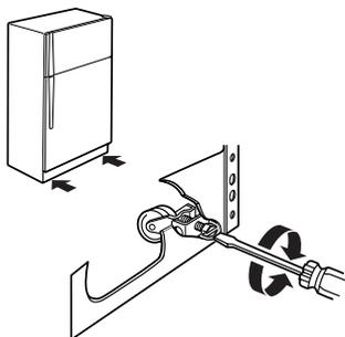
3. Ouvrir les deux portes de nouveau et s'assurer qu'elles se ferment aussi facilement que vous le désirez. Sinon, incliner le réfrigérateur un peu plus vers l'arrière en tournant les deux vis de nivellement vers la droite. Plusieurs tours peuvent être nécessaires et vous devez tourner les deux vis de nivellement de façon égale.
