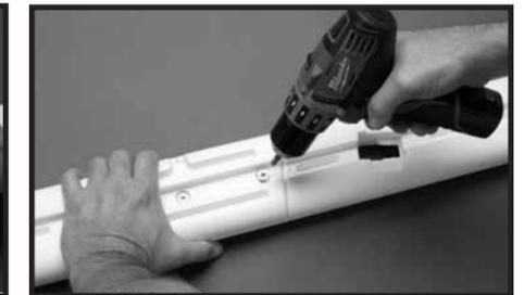
**Étape 1-2 :** Raccordez les montants supérieur et inférieur en vous servant de deux boulons #20 x 1/4 po x 7/8 po et de deux écrous hexagonaux 1/4 po. Répétez le processus pour assembler l'autre montant.
