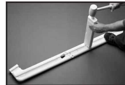
**Étape 2-1 :** Posez le montant assemblé sur une surface plate avec l'entaille de l'extrémité courbée vers le haut. Insérez la marche dans la deuxième ouverture à partir du haut et tapez-la pour l'enclencher. **REMARQUE :** L'entaille à la surface supérieure de la marche doit faire face à l'extrémité courbée du montant.
