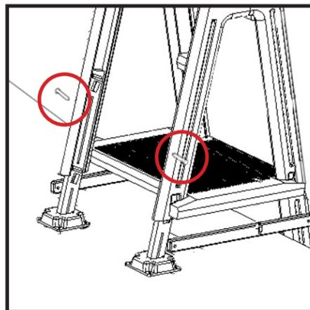
**Étape 4-4 :** En vous assurant que la plate-forme soit de niveau, fixez les montants de retour aux tiges de patte de retour en y insérant quatre vis autotaraudeuses #10 x 1 1/4 po aux endroits marqués (deux vis par montant).
