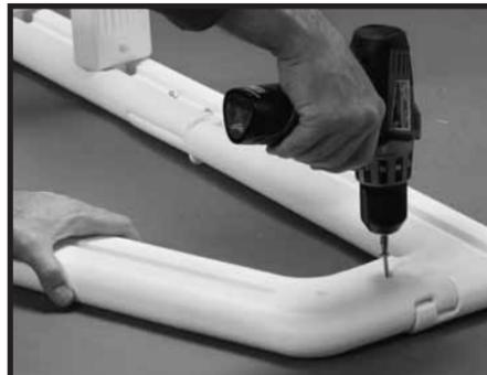
**Étape 2-9 :** Fixez les montants à l'aide de deux vis autotaraudeuses #10 x 1 1/4 po (une sur la marque désignée sur le montant intérieur et une sur le montant extérieur). Retournez l'échelle et répétez la procédure pour l'autre montant de retour.
