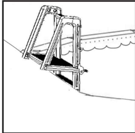
**Étape 4-1 :** Placez l'échelle à l'intérieur de la piscine. À l'aide d'un boyau d'arrosage, remplissez les deux montants par les ouvertures situées sur le dessus des rampes. Penchez l'échelle de part et d'autre pour évacuer tout l'air des marches. **REMARQUE :** Les marches de l'échelle doivent être remplies d'eau pour prévenir que l'échelle ne flotte. Posez les bouchons fournis une fois l'échelle remplie.
