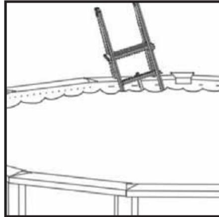
**Étape 4-2 :** Positionnez l'échelle là où elle sera fixée à la terrasse. Assurez-vous que la marche inférieure de l'échelle soit fermement posée sur le fond de la piscine. Faites glisser les tiges des pattes de retour jusqu'à ce que les pattes soient posées à plat sur la surface de la terrasse.
