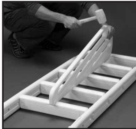
**Étape 2-6 :** Couchez l'échelle et installez la barrière anti-enclavement en l'enclenchant dans les entailles situées sur le dessus des marches. Insérez la partie inférieure en premier.
