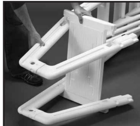
**Étape 2-10 :** Glissez un embout à languette de la plateforme sous les montants de retour le plus près du sol. Tout en faisant légèrement fléchir le montant du dessus vers le bas, faites glisser la plateforme vers le haut de l'échelle jusqu'à ce que les languettes de la plateforme s'insèrent dans les trous de blocage dans les montants.
