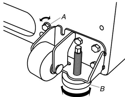
A. Vis de réglage des roulettes arrière
