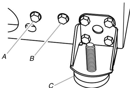
A. Vis de réglage des roulettes arrière
