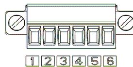
Figure 2.2 PROFIBUS-DP Terminal Block
