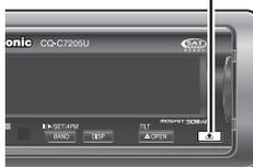
El panel frontal se cierra automáticamente en 5 segundos si estaba abierto o inclinado. La alimentación se desconecta automáticamente cuando la unidad está activada.
