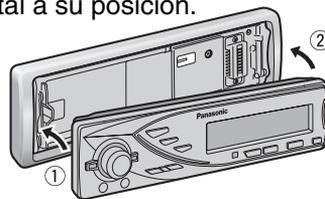
**2** Empuje el extremo derecho del panel frontal hasta oír un “sonido seco” de confirmación.
