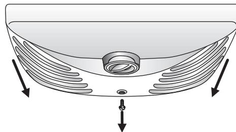
4. Remplacer la ou les ampoule(s) grillée(s) avec une ampoule électrique pour appareil ménager de pas plus de 40 watts.
