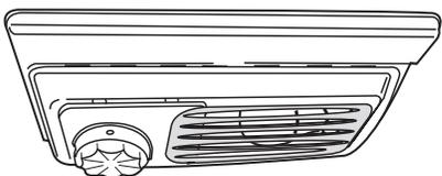
3. Remplacer l'ampoule grillée avec une ampoule pour appareil ménager de pas plus de 40 watts.
