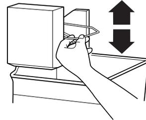
2. Installer la cartouche de filtre d'eau intérieure. La bride de montage du filtre d'eau intérieur est située du côté droit supérieur du compartiment de réfrigération.
