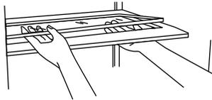
3. Replacer le cadre du couvercle du tiroir à viande dans les supports sur les parois latérales du réfrigérateur et abaisser ou glisser le devant du cadre du couvercle en place.
