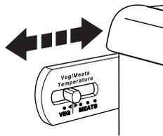
**IMPORTANT :** Si les aliments commencent à geler, déplacer le réglage vers la gauche (moins froid). Se rappeler d'attendre 24 heures entre les ajustements. Avec ce délai, les températures des aliments ont le temps de changer.
