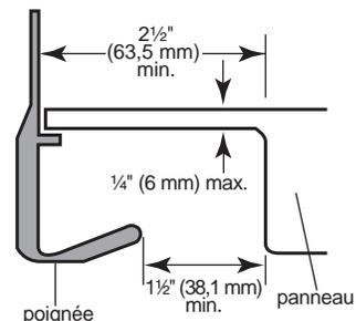
Détail de la garniture dessus, dessous et sur le côté
