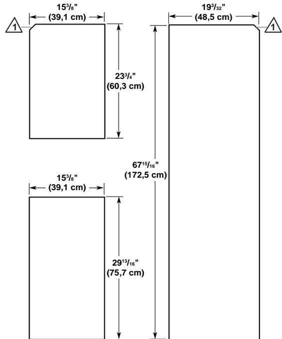
⚠ Chanfrein de 1/8 po x 1/8 po (3,2 x 3,2 mm) requis sur installations avec panneaux personnalisés ou installation avec élément d'appui de 1/4 po.
