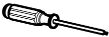
Tournevis à tête de force T 20 ou T 25, selon votre modèle de réfrigérateur
