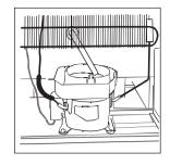
Lassen Sie das Gerät vor Anschluß an das Netz und vor der ersten Inbetriebnahme ca. 4 Stunden lang stehen, bevor es in Betrieb genommen werden darf. Andernfalls könnte der Kompressor beschädigt werden. Während der Ruhephase kann das Öl zum Kompressor zurückfließen.
