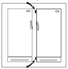
Bitte prüfen, dass das Netzkabel und/oder Netzstecker nicht von der Geräterückseite eingeklemmt und beschädigt wird.
