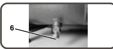
**6). ROBINET DE PURGE DU RÉSERVOIR D'AIR :** Ce robinet de purge est utilisé pour évacuer l'humidité du réservoir d'air après l'arrêt du compresseur. **Ne JAMAIS essayer d'ouvrir ce robinet quand il y a plus de 10 psi (0,68 bar) de pression dans le réservoir d'air !** Pour ouvrir ce robinet de purge, tournez son bouton dans le sens du dévissage. Penchez le réservoir pour vous assurer que toute l'eau coule bien par le robinet.
