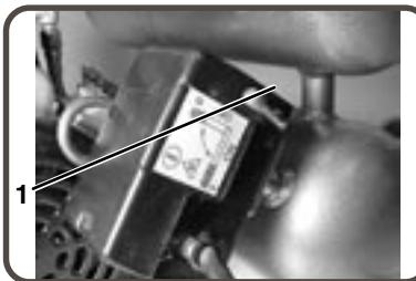
**2). SURCHARGE DU MOTEUR :** Le moteur comporte un disjoncteur de protection situé sur la pompe. Un ampérage tiré trop important fait sauter ce disjoncteur pour protéger le moteur et l'opérateur. Réinitialisez le disjoncteur en repoussant la tige plastique noire dans le carter. Repositionnez le commutateur s'il a disjoncté.
