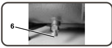
**6) VÁLVULA DE PURGA DEL TANQUE DE AIRE:** Esta válvula se usa para purgar la humedad del tanque (tanques) de aire después que se apaga el compresor de aire. NUNCA intente abrir la válvula de purga cuando la presión en el tanque es superior a 10 psi! Para abrir la válvula de purga, gire la perilla en sentido contrario a las agujas del reloj. Incline el tanque para asegurarse que toda la condensación se vacíe a través de la válvula.
