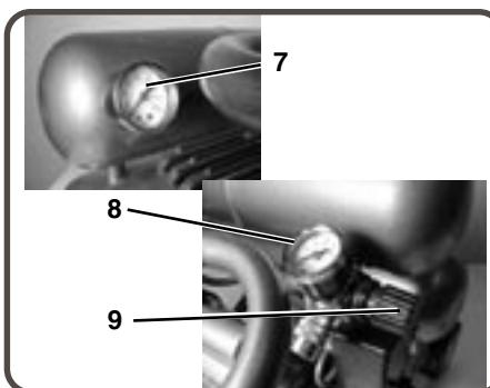
**7). MANOMÈTRE DE RÉSERVOIR D'AIR :** Ce manomètre indique la pression de l'air comprimé en réserve dans le réservoir d'air.
