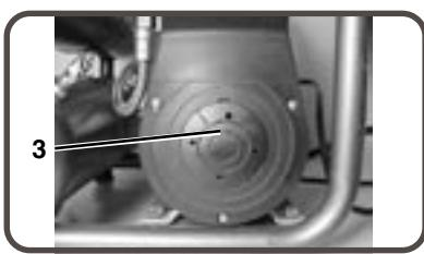
**4) BOMBA DEL COMPRESOR DE AIRE:** Para comprimir el aire, el pistón sube y baja en el cilindro. En la carrera descendente, la válvula de admisión aspira aire del exterior mientras la válvula de escape permanece cerrada. En la carrera ascendente, el aire se comprime, la válvula de admisión se cierra y el aire comprimido es forzado al exterior a través de la válvula de escape al tubo de descarga, a través de la válvula de retención (antirretorno) y al interior del tanque de aire.
