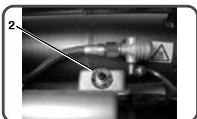
**3) FILTRO DE ADMISIÓN DE AIRE:** El filtro está diseñado para limpiar el aire que entra a la bomba. Para asegurar que la bomba recibe continuamente un suministro de aire seco, frío y limpio, este filtro debe estar siempre limpio y los orificios de venteo libres de obstrucciones. El filtro puede sacarse para limpiarlo con agua tibia jabonosa. Enjuague el filtro y déjelo secar al aire.
