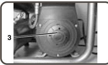
**4). POMPE DU COMPRESSEUR D'AIR :** Pour compresser l'air, le piston monte et descend dans le cylindre. Dans le mouvement de descente, l'air est aspiré par la soupape d'admission, tandis que la soupape d'échappement reste fermée. Dans le mouvement de remontée, l'air est compressé, la soupape d'admission se ferme et l'air comprimé est chassé par la soupape d'échappement dans la conduite d'échappement, au travers du clapet anti-retour puis dans le réservoir d'air.
