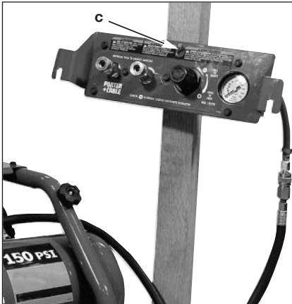
**⚠ AVERTISSEMENT** Peut causer des blessures graves ou la mort. Le réservoir peut contenir une pression d'air de 150 PSI. Ne connectez jamais les accessoires à l'air non régulé. N'utilisez jamais les outils ou les accessoires à une pression supérieure à la pression maximale indiquée.
