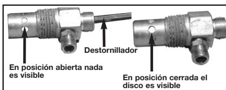
8. Limpie o reemplace la válvula reguladora. Un solvente, tal como un removedor de pintura o de barniz puede usarse para limpiar la válvula reguladora.
