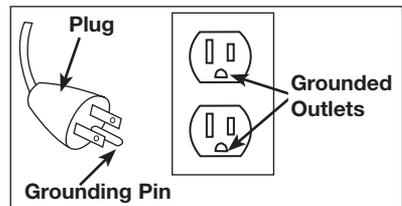
**⚠ WARNING** **IMPROPER GROUNDING CAN RESULT IN ELECTRICAL SHOCK.**
