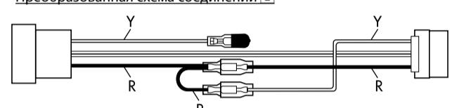
**B Connections without using the ISO connectors / Anschlüsse ohne Verwendung der ISO-Steckverbinder / Подключение без использования разъемов ISO**
