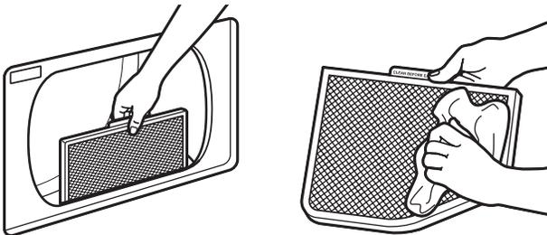
Nettoyer le filtre à charpie avant chaque charge. Enlever le filtre à charpie en le tirant tout droit vers le haut. Enlever la charpie du filtre en la roulant avec les doigts. Ne pas rincer ni laver le filtre pour enlever la charpie. Remettre le filtre à charpie fermement en place.
