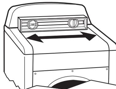
Puis, en plaçant un niveau dans la zone située sur le côté de la sécheuse, entre la partie supérieure et la caisse de la sécheuse, vérifier l'aplomb dans le sens avant/arrière.
