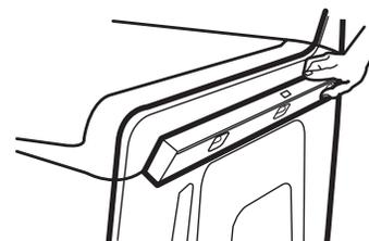
Si la sècheuse n'est pas d'aplomb, la relever à l'aide d'un bloc de bois. Utiliser une clé pour ajuster les pieds vers le haut ou vers le bas, et vérifier à nouveau si elle est d'aplomb.
