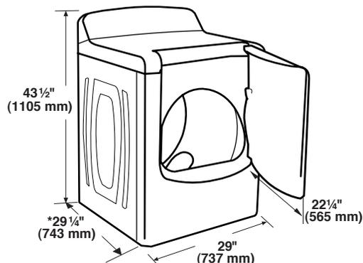
\*La plupart des installations requièrent un espace minimum de 5" (127 mm) derrière la sécheuse pour le conduit d'évacuation avec coude. Voir "Exigences concernant l'évacuation".
