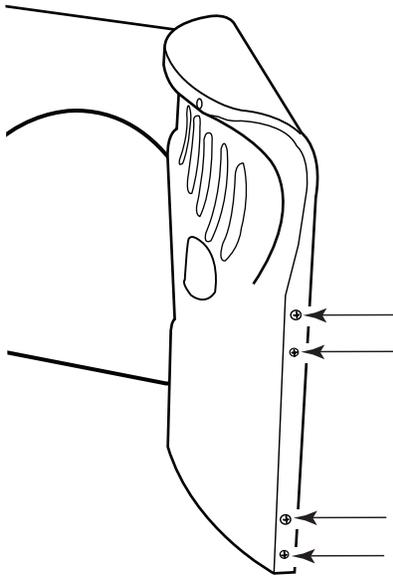
4. Installer les deux charnières sur le panneau avant de la sécheuse à l'aide de quatre vis. Utiliser le côté sans fente pour fixer la charnière sur le panneau avant.
