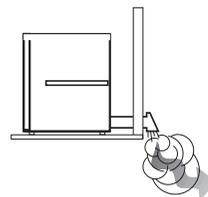
2. Utilisez un conduit d'évacuation métallique rigide de 10,2 cm. Scellez tous les joints à l'aide d'un ruban adhésif, y compris au niveau du sèche-linge. N'utilisez jamais de vis, qui entraînent l'accumulation de peluches.
