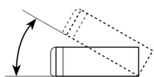
Install the unit at an angle of less than 30°. Установите устройство под углом менее 30°.
