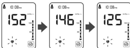
4. Una vez finalizada la medición, el brazalete se desinfla por completo. Aparecen en pantalla la presión arterial y la frecuencia del pulso.
