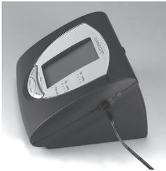
2. Para usar su modelo 1157 sin baterrias, use unicamente el adaptador incluido de lumiscope. Conecte el adaptador de corriente primero al tensiometro 1157 y despues al toma corriente electrico.
