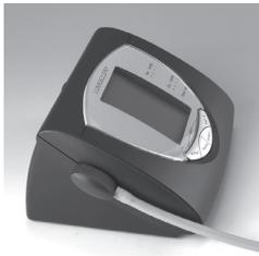
4. Conecte la abrazadera al tensiometro 1157. Las dos puntas entraran perfectamente en los dos orificios al lado izquierdo de la unidad de solo una forma, con el tubo del aire dirigido hacia usted.
