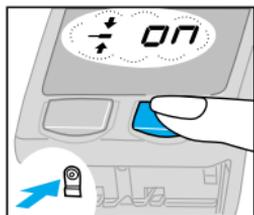
Le mot « on » sera remplacé par « - - » [Arrêt] sur l'écran d'affichage.
