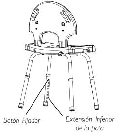
FIGURA 3 - AJUSTANDO LAS EXTENSIONES DE LAS PATAS
