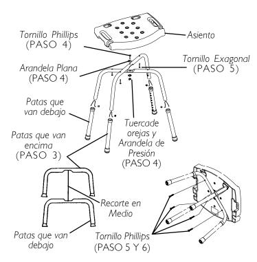
FIGURA I - ENSAMBLANDO EL ASIENTO PARA BAÑARSE
