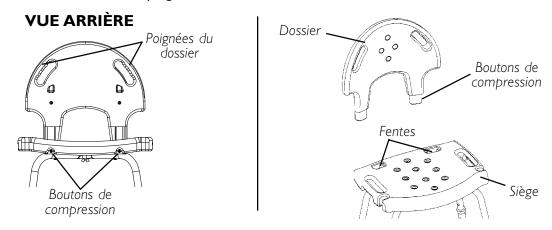
FIGURE 2 - INSTALLER/ENLEVER LE DOSSIER DU MODÈLES 9681P ET 9681
