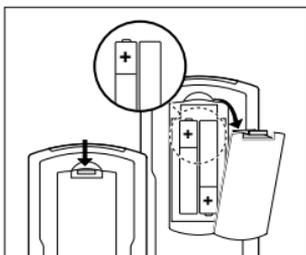
Você irá precisar de duas pilhas de 1,5V; utilize apenas pilhas do tipo UM3, LR6 ou AA. Coloque-as no compartimento conforme ilustrado:
