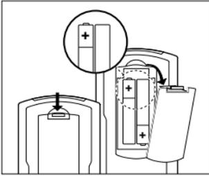
U heeft twee 1,5 V-batterijen nodig, type UM3, LR6 of AA. Plaats de batterijen als volgt.
