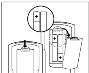
Necesitará dos pilas de 1,5V, tipo UM3, LR6 o AA. Póngalas así:
