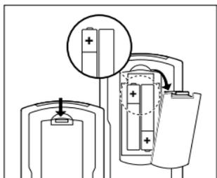
Du trenger to 1,5V batterier, bare type UM3, LR6 eller AA. Sett dem i slik:
