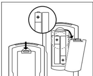
Sie benötigen zwei Batterien 1,5 V - aber nur vom Typ UM3, LR6 oder AA. Setzen Sie sie so ein:
