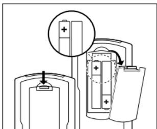
Du behöver två batterier på 1,5V, endast typ UM3, LR6 eller AA. Sätt i dem så här:
