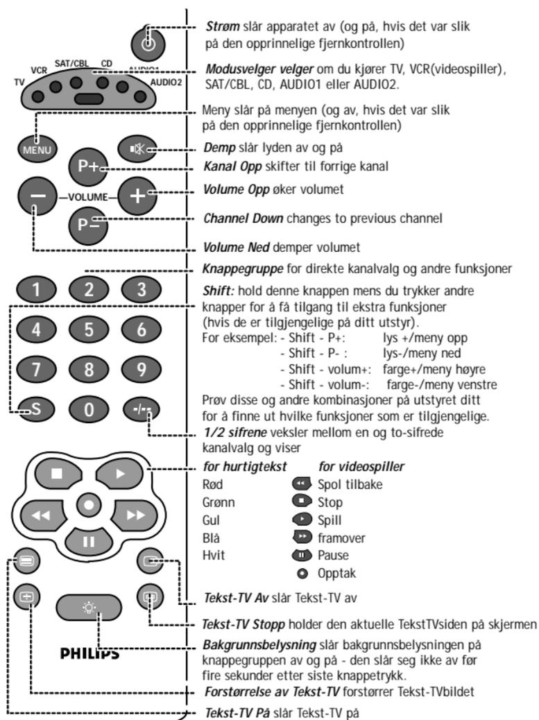
**Prøv deg fram!** Den letteste måten å finne ut hvordan fjernkontrollen virker, er å prøve å trykke på knappene for å se hva som skjer – ikke vær redd, du kan ikke ødelegge noe! De fleste knappene virker på samme måte som på den opprinnelige fjernkontrollen din. Om du trykker på en knapp for en spesiell funksjon har den selvsagt ingen virkning hvis ikke din TV eller videospiller har denne funksjonen.
