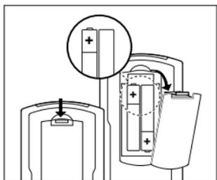
Dovrete utilizzare solo due pile da 1,5V, tipo UM3, LR6 o AA. Inseritele in questo modo.
