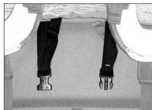
Stecker und Gehäuse des Steckverschlusses bei mittiger Montage
