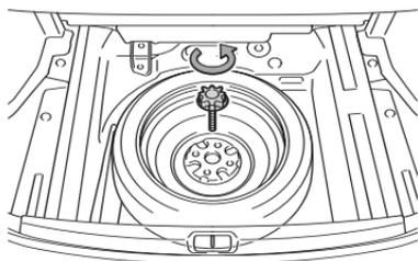
Loosen and remove the bolt.
