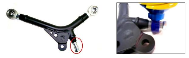
Step 2: Attach top shock to upper strut mount. See Photo.
