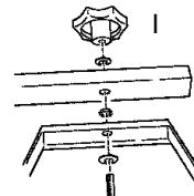
**Étape 3 :** Pour attacher la barre d'assemblage de lumière au poteau à coulisse, positionner le trou au milieu de la barre d'assemblage de lumière par-dessus la vis filetée sur le poteau. **REMARQUE :** Le grand trou dans la barre d'assemblage de lumière devrait être orienté vers le bas pour s'adapter sur l'écrou déjà en place. Une fois la barre d'assemblage de lumière mise en place, positionner le trou de la boîte de connexion sur la vis filetée. Serrer le bouton de fixation (J).
