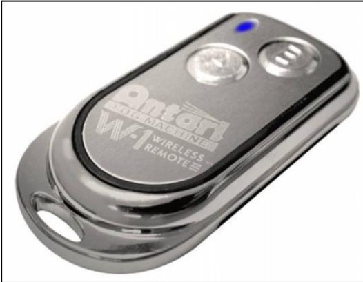
Mit der Sendeeinheit lässt sich der Nebelausstoß per Funkübertragung über eine Distanz von bis zu 50 Metern auslösen. Mit einer adressierten Fernbedienung lässt sich eine unbegrenzte Anzahl von Maschinen parallel steuern. Drücken Sie die Taste "A", um den Nebelausstoß auszulösen. Zur Kontrolle leuchtet die blaue LED. Um den Nebelausstoß zu stoppen, drücken Sie die Taste "B".
