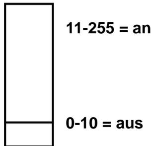
**Zwischen den Werten 0 und 10 von Steuerkanal A ist die Maschine aus.
