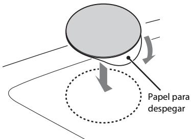
Deje pasar 24 horas luego de haber colocado la lámina de montaje antes de colocar el soporte en ella.
