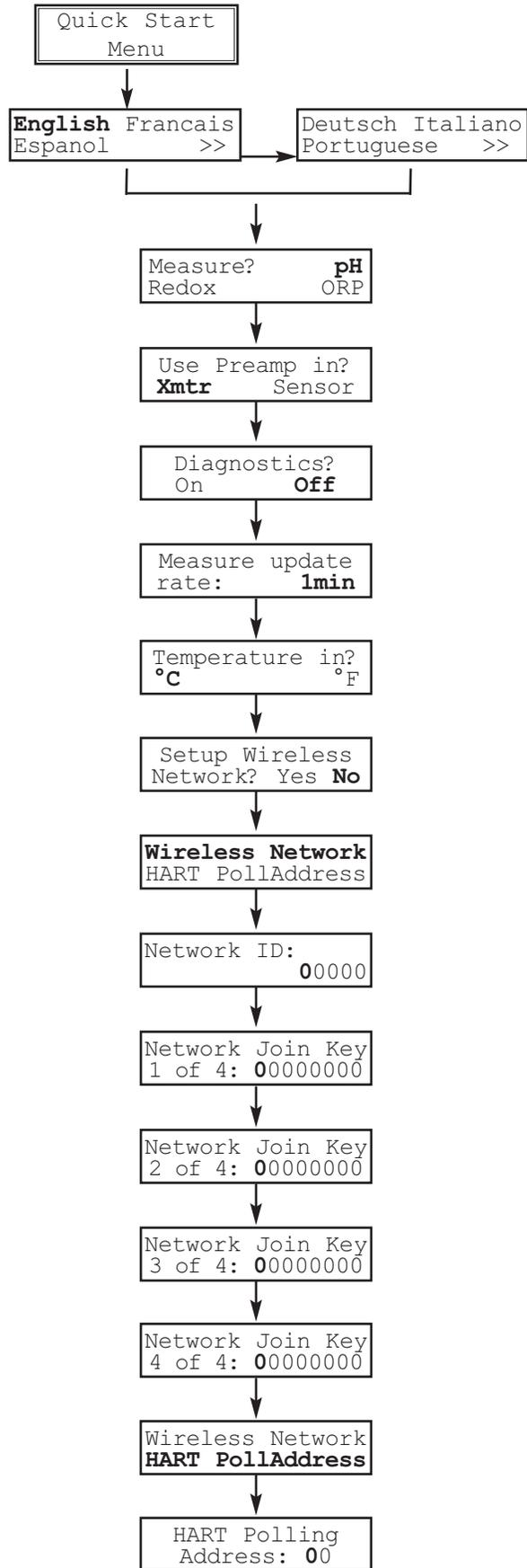
FIGURE 1-1. MENU TREE FOR MODEL 6081 pH Wireless TRANSMITTER
