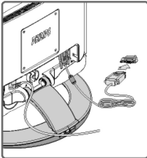
**Observación:** Si utiliza un Apple Macintosh, deberá conectar el adaptador especial de Mac a un extremo del cable de señal del monitor.
