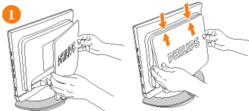
Alinee la cubierta con la ranura de ventilación.
