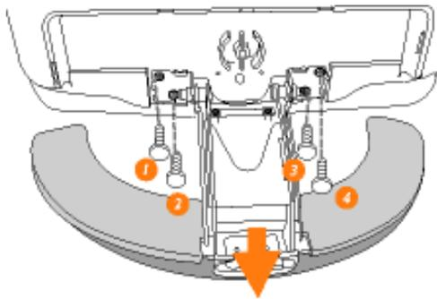
2) Extraiga los 4 tornillos y retire la base del monitor LCD.
