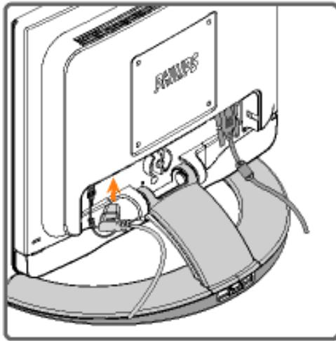
**1)** Conecte firmemente el cable de alimentación al monitor.
