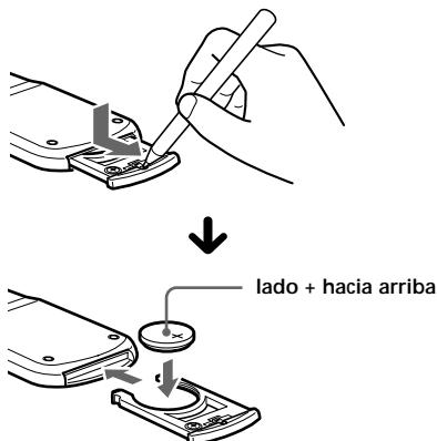
Sustituya la pila por una de litio DL-2025 de Duracell o CR2025 de Sony. El uso de otro tipo de pila puede comportar riesgos de incendios o explosión.
