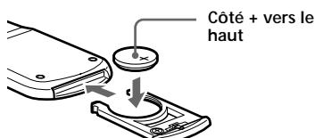
Remplacez la pile par une pile au lithium CR2025 Sony ou DL-2025 Duracell. L'utilisation d'une autre pile comporte un risque d'incendie ou d'explosion.
