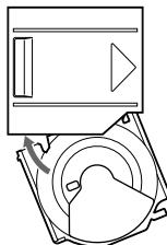
Con la parte recortada de la bandeja hacia fuera, inserte la esquina derecha de dicha bandeja en la ranura y, a continuación, presione la esquina izquierda para introducirla hasta oír un chasquido.
