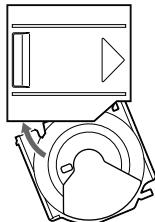
L'encoche du plateau étant face à vous, introduisez l'angle droit du plateau dans la fente et poussez ensuite sur l'angle gauche jusqu'à ce qu'il s'encliquette.
