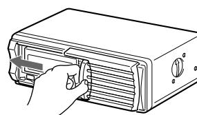
Emplee el cargador de discos suministrado o el XA-250. El cargador de discos XA-10B/XA-350 no puede utilizarse con esta unidad. Si emplea otro tipo de cargador de discos, pueden producirse fallos de funcionamiento.
