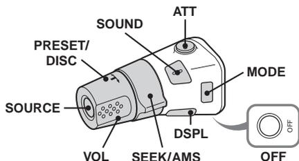
Les commandes suivantes du satellite de commande ont une fonction différente de celles de l'appareil.
