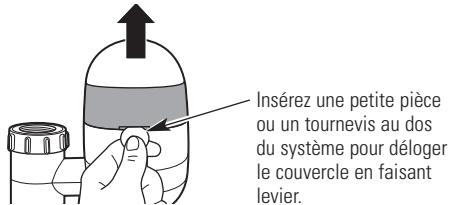
**3** Retirez l'emballage et l'étiquette sur le dessous du nouveau filtre. Puis installez le nouveau filtre. **Assurez-vous de bien tenir le boîtier du filtre dans la main. Puis, placez fermement le nouveau filtre dans le boîtier. Puis, tournez le filtre dans le sens des aiguilles d'une montre en serrant à la main. Continuez à tourner jusqu'à l'alignement de l'onglet avec l'icône << non-filtré >> tel qu'il est montré :**
