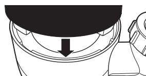
**NOTA:** La tapa está diseñada para calzar en la carcasa del filtro sólo en un sentido.
