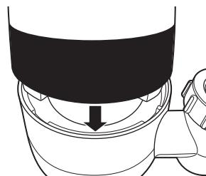
**NOTA:** La tapa está diseñada para calzar en la carcasa del filtro sólo en un sentido.
