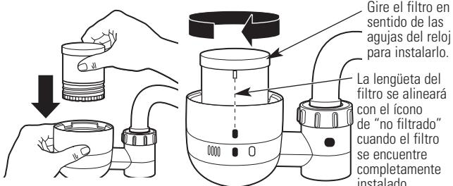
**5** Alinee la tapa con la carcasa del filtro (luces en el frente) y presiónela hacia abajo.
