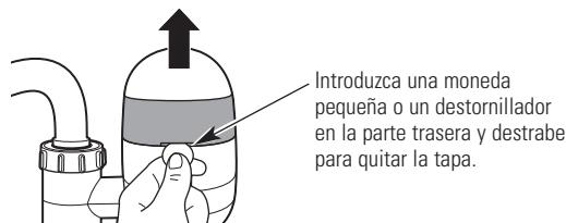
**3** Quite el cartucho del filtro usado girando en sentido contrario a las agujas del reloj. **Asegúrese de sostener el grifo y la carcasa del filtro cuando quite el filtro para evitar daños.** Deseche el filtro usado.
