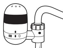
**AVERTISSEMENT** – Ne pas essayer de filtrer une eau chaude à une température supérieure à 37,7°C (100°F). La cartouche de filtration serait endommagée et sa performance diminuée.
