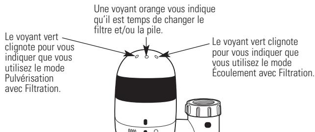
Le voyant orange clignote une fois à quelques secondes d'intervalle pour vous rappeler qu'il est temps de changer le filtre. Le voyant orange clignote rapidement trois fois à quelques secondes d'intervalle pour vous rappeler qu'il est temps de changer le filtre et la pile.
