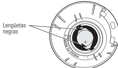
**6** Vuelva a colocar la tapa de las baterías. Utilice las flechas de alineación para garantizar que la tapa se encuentre en la posición correcta. Utilizando una moneda pequeña o un destornillador, gire en sentido de las agujas del reloj para trabar en su lugar.
