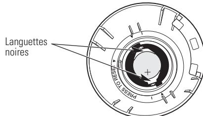
**6** Repositionnez le couvercle de la pile. Utilisez les flèches d'alignement pour vous assurer que le couvercle est dans la bonne position. A l'aide d'une petite pièce ou d'un tournevis, tournez dans le sens des aiguilles d'une montre pour le verrouiller.
