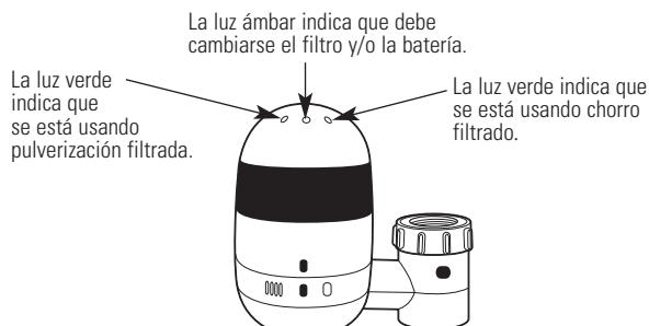
La luz ámbar destellará una vez cada varios segundos para recordarle que debe cambiar el filtro. La luz ámbar dará tres destellos rápidos cada varios segundos cuando deba cambiarse la batería y el filtro.
