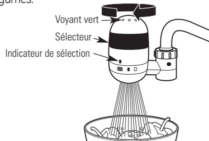
**REMARQUE :** Il n'est pas nécessaire de maintenir le couvercle en position pour continuer à recevoir de l'eau filtrée.
