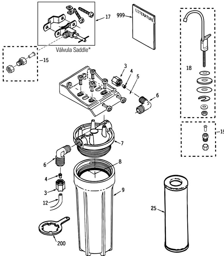
**\*NOTA:** Los códigos del estado de Massachusetts requieren que la instalación sea hecha por un plomero licenciado y no permiten el uso de una válvula tipo "saddle". Para la instalación, use el código de plomería 248-CMR del Commonwealth de Massachusetts.
