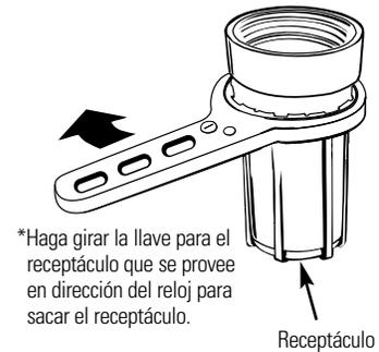
\*Haga girar la llave para el receptáculo que se provee en dirección del reloj para sacar el receptáculo.
