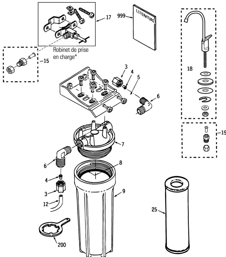
**\*NOTE :** Dans l'État du Massachusetts, les codes en vigueur exigent que cet équipement soit installé par un plombier licencié, et que le raccordement à la canalisation d'alimentation ne soit pas effectué par un robinet de prise en charge. Avant l'installation, consulter le code de plomberie 248-CMR du Commonwealth of Massachusetts.
