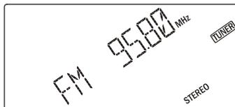
Für Stereosender mit schlechtem Empfang empfehlen wir Umschaltung auf Mono, Tastendruck auf **ST / MO** schaltet von STEREO auf MONO um.
