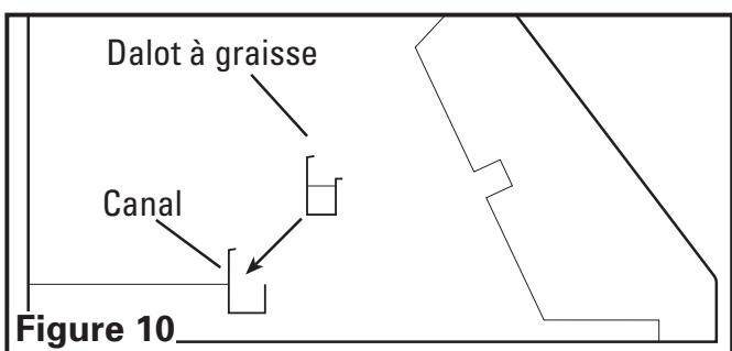
3. Installer les filtres déflecteurs avec les barres d'espacement qui sont requises en insérant le dessus du filtre dans le canal du haut de la hotte, puis glisser le bas du filtre dans le canal du bas. Dans les modèles avec espaces, il est plus facile d'installer le(s) espaceur(s) d'abord et les filtres à graisse en dernier (**Figure 11**).
