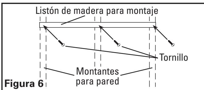
**PRECAUCIÓN:** DEBIDO AL PESO DE LA CAMPANA, ASEGÚRESE QUE EL LISTÓN DE MADERA ESTÉ SUJETADO A TODOS LOS MONTANTES PARA PARED DISPONIBLES (UN MÍNIMO DE 2 MONTANTES PARA CAMPANAS DE 762 mm, Y MÁS CANTIDAD A MEDIDA QUE EL ANCHO SE INCREMENTE) NO SOLAMENTE AL PANEL DE YESO.
