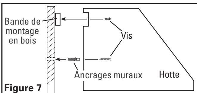
4. Faire reposer la cavité sur le côté arrière de la hotte sur la bande de bois et fixer à la bande de bois avec les vis de 1,9 cm comprises au travers des trous dans l'arrière de la hotte qui s'alignent avec la bande de bois (utiliser les 6 vis pour les largeurs de 76,2 et de 91,4 cm et 8 vis pour les largeurs supérieures). Fixer le bas de la hotte en installant les vis fournies avec les ancrages muraux. (**Figure 7**).
