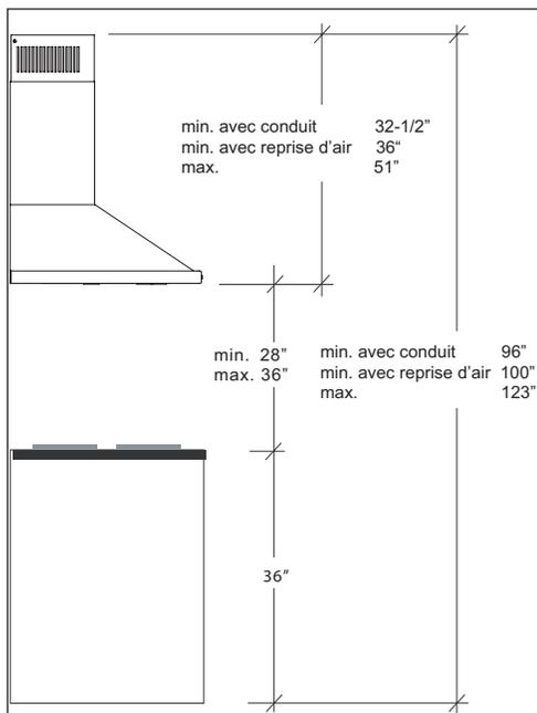
Note : La pièce de recouvrement de conduit supérieure avec grille d'aération peut être tournée à l'envers afin de cacher les ouvertures des grilles.
