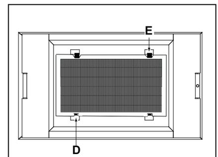
Installez les filtres à charbon dans le support à filtre (côté plastifié vers l'extérieur). Insérez d'abord le côté D du filtre (avec les languettes) dans le support. Fixez le filtre à charbon en place en poussant le côté E dans les languettes d'accrochage.
