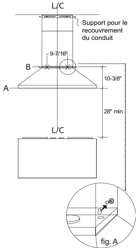
La configuration de reprise sans conduit a été conçue pour les applications où il est impossible d'installer un conduit d'aération. Lorsque transformée, la hotte fonctionne comme une hotte de reprise d'air plutôt que comme un système d'évacuation d'air. Les vapeurs et fumées de cuisson sont aspirées et filtrées par un ensemble optionnel de filtres à charbon. L'air est ensuite purifié et redirigé à l'intérieur de la maison.
