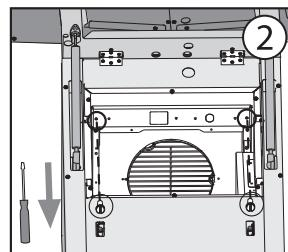
5. Regule el ancho de la abrazadera de sostén de la chimenea para que quede dentro de la chimenea superior y respetando la distancia indicada en la fig. 4
