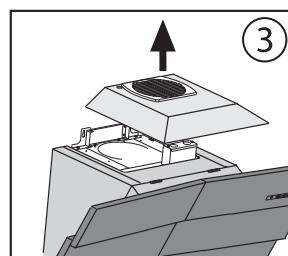
8. Introduzca la chimenea superior dentro de la chimenea inferior. Coloque las chimeneas en su lugar en la campana.
