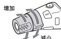
若需要將旋轉式控制器安裝在汽車方向盤軸的右側，您可以將控制器的操作方向反置。
