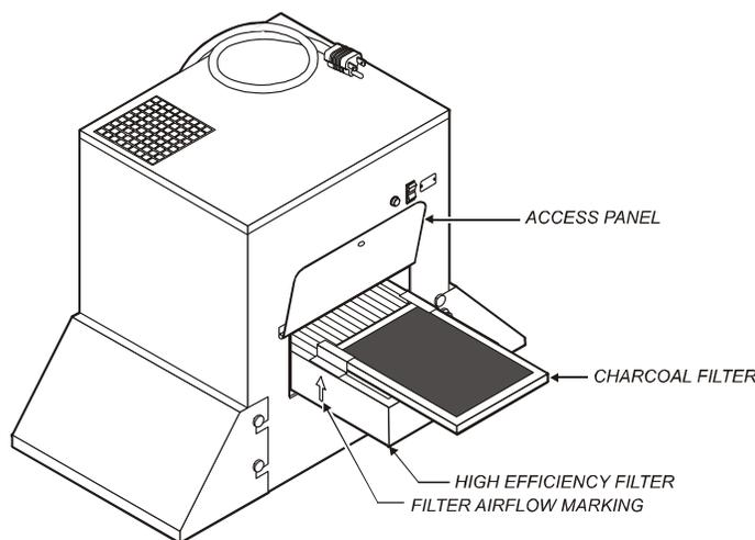
*Fig. 5 Filter Installation*
