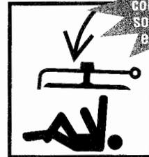
EVITE EL APLASTAMIENTO coloque bloques o soportes seguros en la segadora
