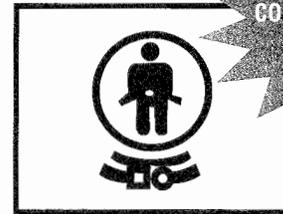
USE UNA ESTRUCTURA CONTRA VUELCOS (ROPS) y el cinturón de seguridad
